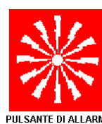
PULSANTE DI ALLARME ANTINCENDIO
